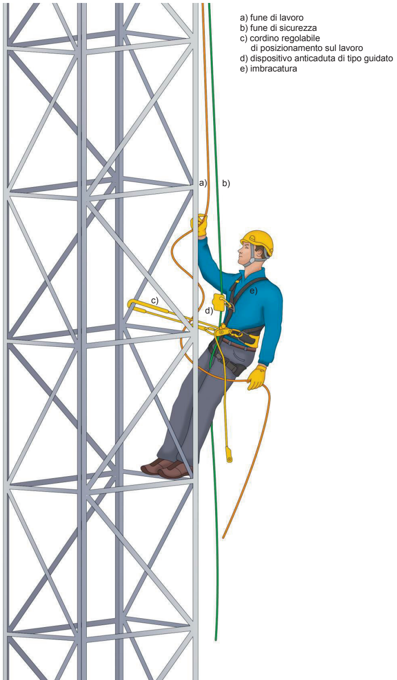
Figura 2 - Esempio di un sistema di posizionamento sul lavoro
